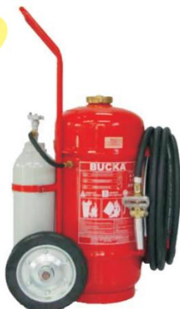
Extintor de incêndio sobre rodas, com carga de pó químico seco à base de fosfato monoamônico (Totalit Super ABC), fabricado de acordo com a norma NBR 15809. Fabricado em chapa de aço carbono com pressurização indireta através de cilindro de nitrogênio 7L com 130 kgf/cm<sup>2</sup> em aço carbono SAE 1541 com válvula ABL em latão forjado, dotado de manômetro.
